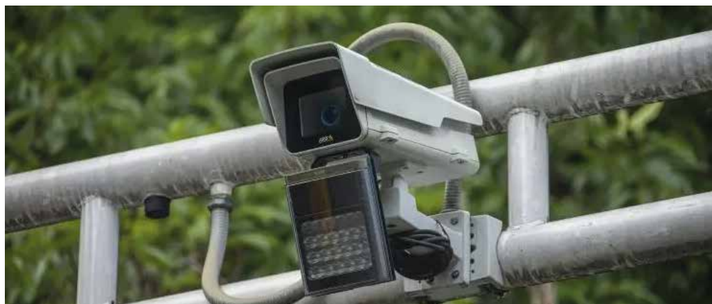
Cámara LPR, es un sistema capaz de detectar, y reproducir digitalmente los caracteres de la placa de un vehículo por medio de captura de video.
